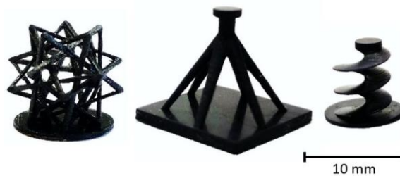
Figura 2.10. Ejemplos de piezas impresas mediante DLP de geometría compleja dopadas con 0.1 % en peso de MWCNT.
