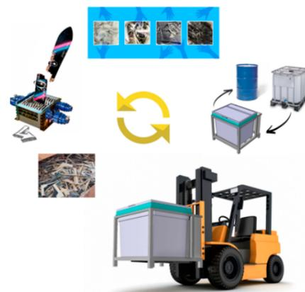
La posibilidad de reciclar composites está basada en la **innovación química** de resinas epoxi que permite descomponer la resina endurecida y disolverla. En el proceso de desprenden los materiales de la matriz, tejidos, cores y la resina se recupera en forma de termoplástico.
