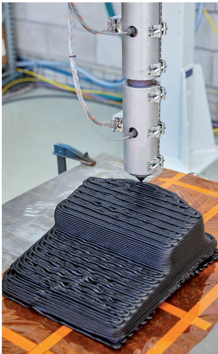
Impresión 3D de material termoplástico reforzado con carbono | Cortesía de Tecnalia
