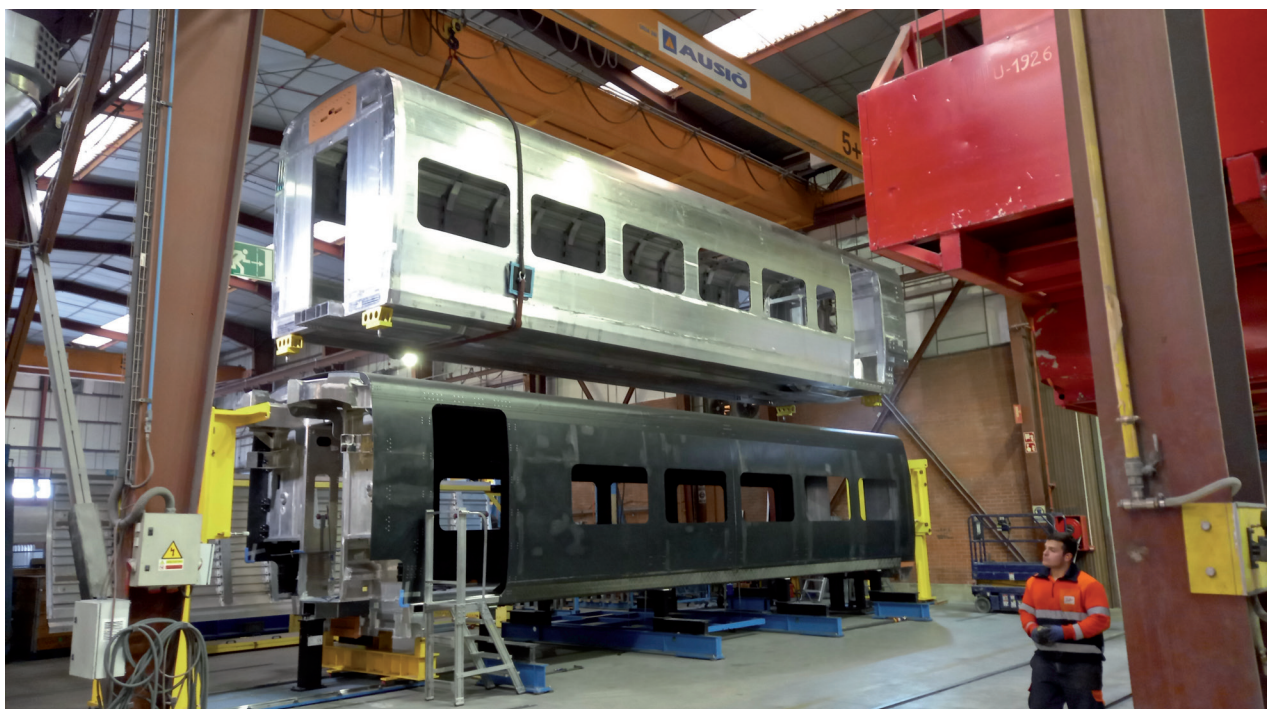
Das generaciones de estructuras de caja, aluminio (arriba) e híbrida CFRP-Aluminio (abajo) | Cortesía de TALGO
