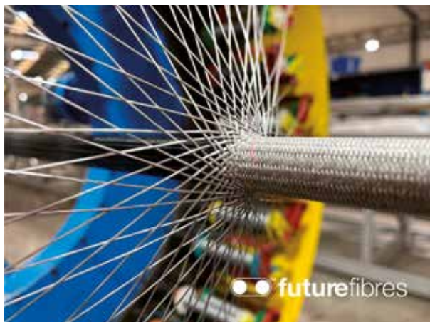
Proceso de recubrimiento de cables, mediante el trenzado de fibras de altas prestaciones
