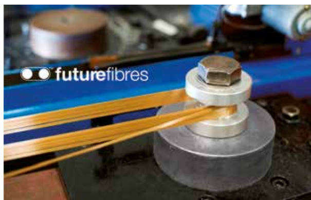
Proceso de fabricación de cables de PBO, tipo Wound Fiber Core
