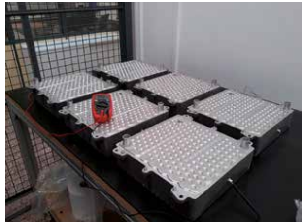
Módulos de baterías, fabricados por Industrias Alegre en PP mediante la tecnología MJF de HP
