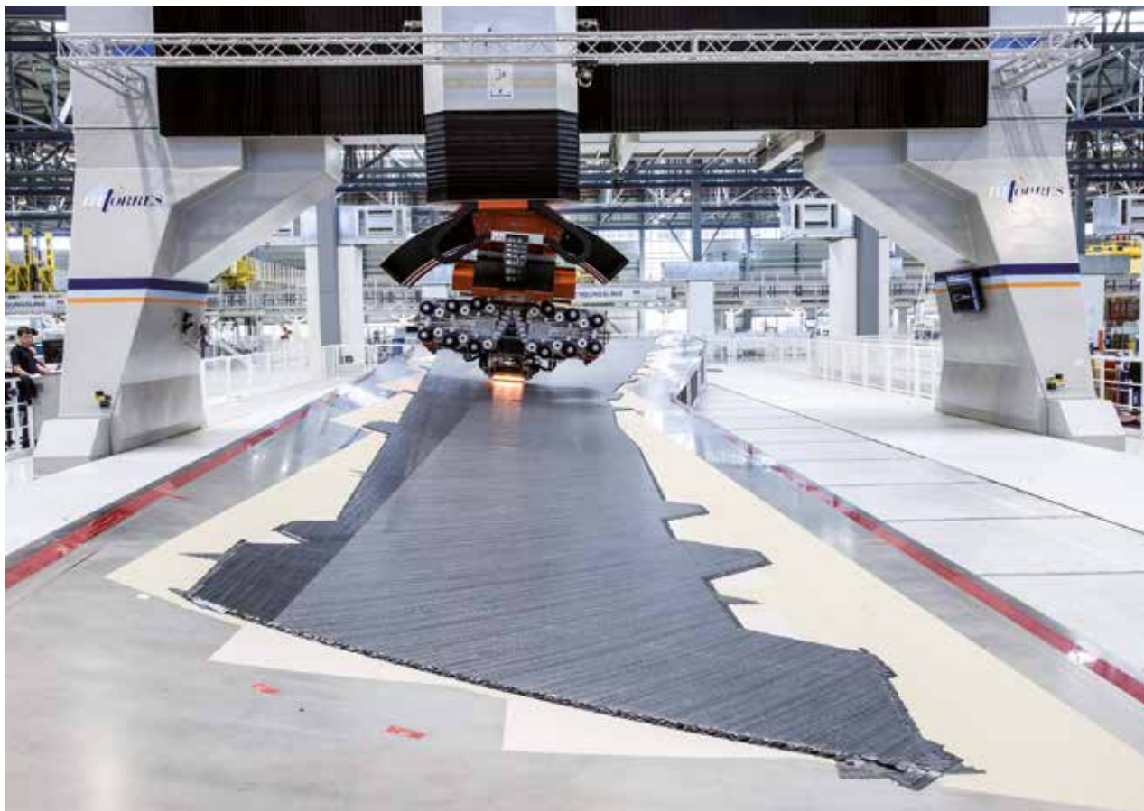
Máquina Torresfiberlayup, híbrida ATL y AFP fabricando las pieles de las alas del Airbus A350XWB
