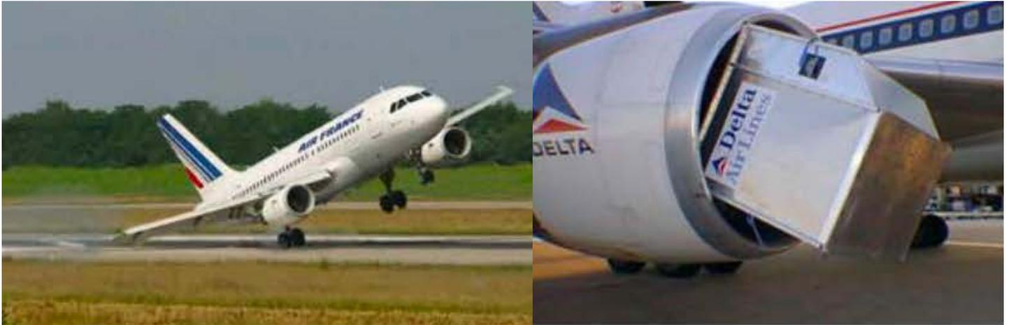
*Ilustración 2-7: Daños fortuitos en una aeronave.*
