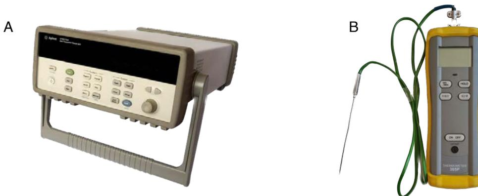
*Ilustración 3-9: Equipos de control: A) Agilent 34970A, B) Termopar Thermometer 305P*
