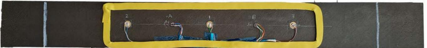
*Ilustración 3-12: Reducción de rebotes mediante pasta de vacío*
