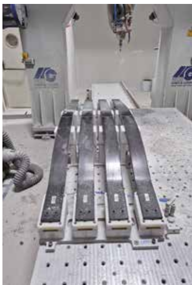
Proceso de mecanizado de hojas de composite, aplicado por Ziur Composites
