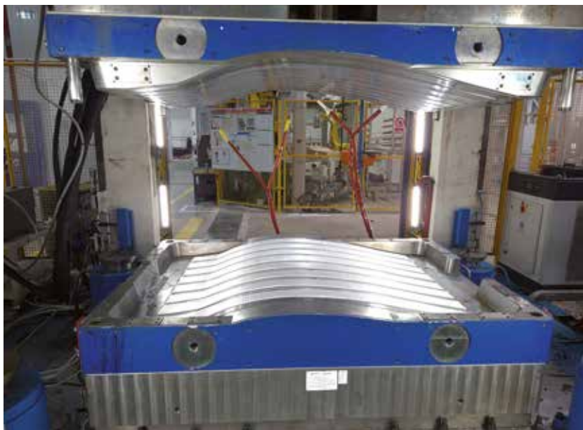
Proceso de inyección CRTM para la impregnación de preformas, aplicado por Ziur Composites en molde multicavidad con capacidad para 8 unidades
