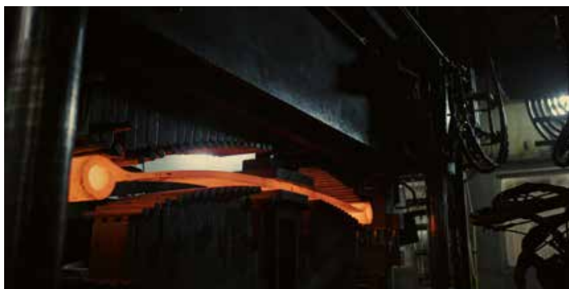
Hoja de ballesta de acero de alta resistencia a más de 900°C a la salida del horno, antes de la operación de temple y revenido
